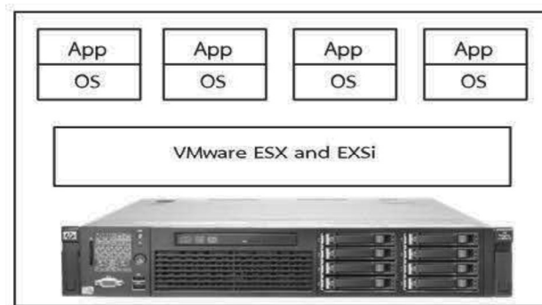
ภาพที่ 1 โครงสร้างการทำงานโปรแกรม VMware (คชา สมทา, 2555)
